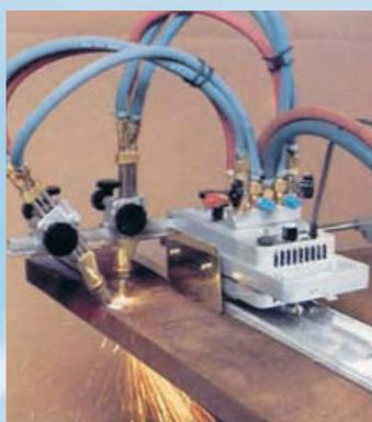
IMP mit einseitig angeordneten Brennern für Schweißkantenschnitte
